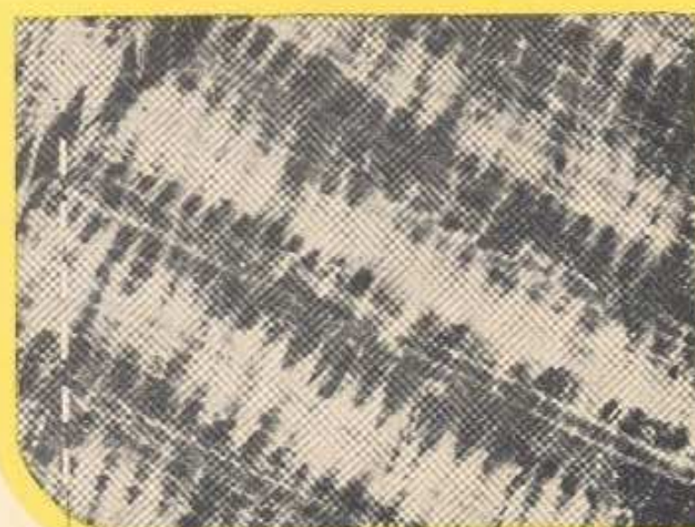
कम जले हुए चावल छिलके की एस ई एम (आन्तरिक भाग) 320 × (प्लेट 3)
