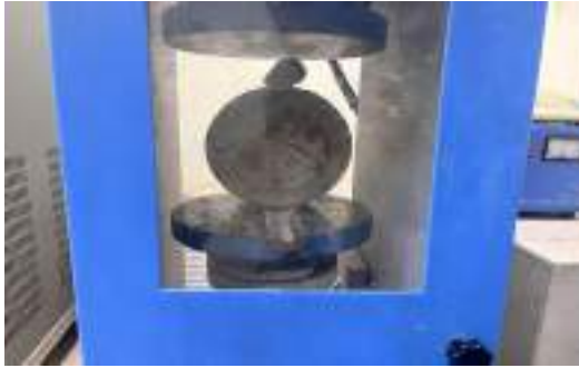
पानी की गहराई की पैठ मापने के लिए लेपित कंक्रीट सिलेंडर के नमूने को दो हिस्सों में तोड़ा जा रहा है
