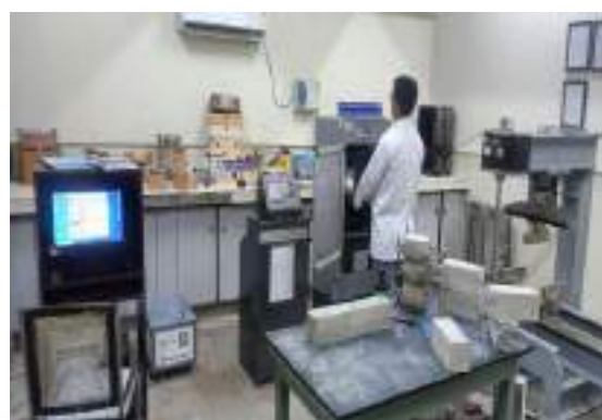
कंक्रीट की लचीली कठोरता के निर्धारण के लिए तनाव नियंत्रित फ्लेक्सुरल परीक्षण मशीन
