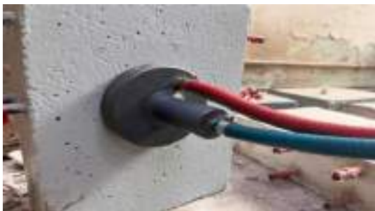
लेपित कंक्रीट स्लैब नमूने पर वायु पारगम्यता परीक्षण किया जा रहा है
