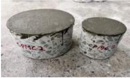
परीक्षण से पहले व्यास 100 मिमी और 150 मिमी के कंक्रीट बेलनाकार नमूने तैयार/लेपित करें।
