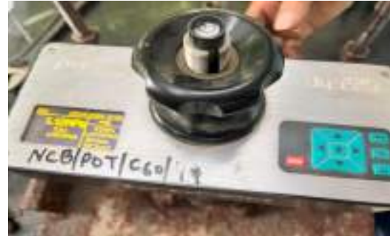
लेपित कंक्रीट नमूने पर पुल-ऑफ आसंजन परीक्षण किया जा रहा है
