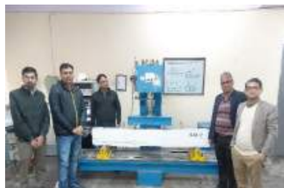
चार-बिंदु मोड़ परीक्षण में बीम के परीक्षण के लिए परीक्षण स्थापित किया गया
