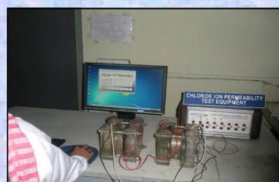
**RAPID CHLORIDE PERMEABILITY TEST**
